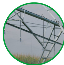
Angoli di compressione incrociati Crossed angle stabilizers
